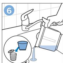
**6** Leeren Sie die Glaskanne, und entfernen Sie die Filtertüte mit den Kalkrückständen.
